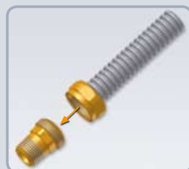
Upewnij się, że powierzchnia uszczelnienia jest czysta i bez uszkodzeń
